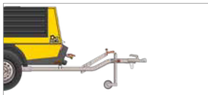
Zugdeichsel starr ohne Auflaufbremse, mit Parkbremse
